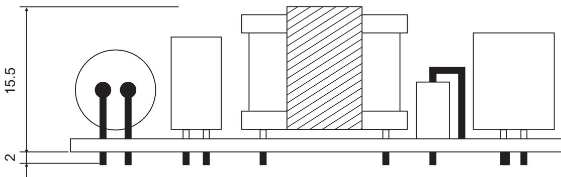
注: 此图为PCB导出尺寸, 误差为( $\pm 1\text{mm}$ )详细尺寸请根据实物为准
